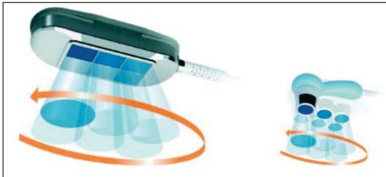
Рис. 7. Принцип роботи випромінювача з технологією Hands Free Sono® (зліва) і звичайного випромінювача, яким рухає оператор (справа)
